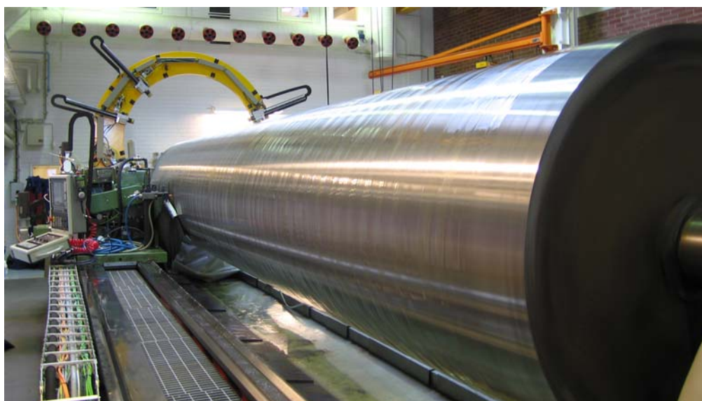
Kuva 3.1–1. Mallitettava koetela TKK:n Koneensuunnittelun laboratorion telahallin hiomakoneella 31.5.2006.
