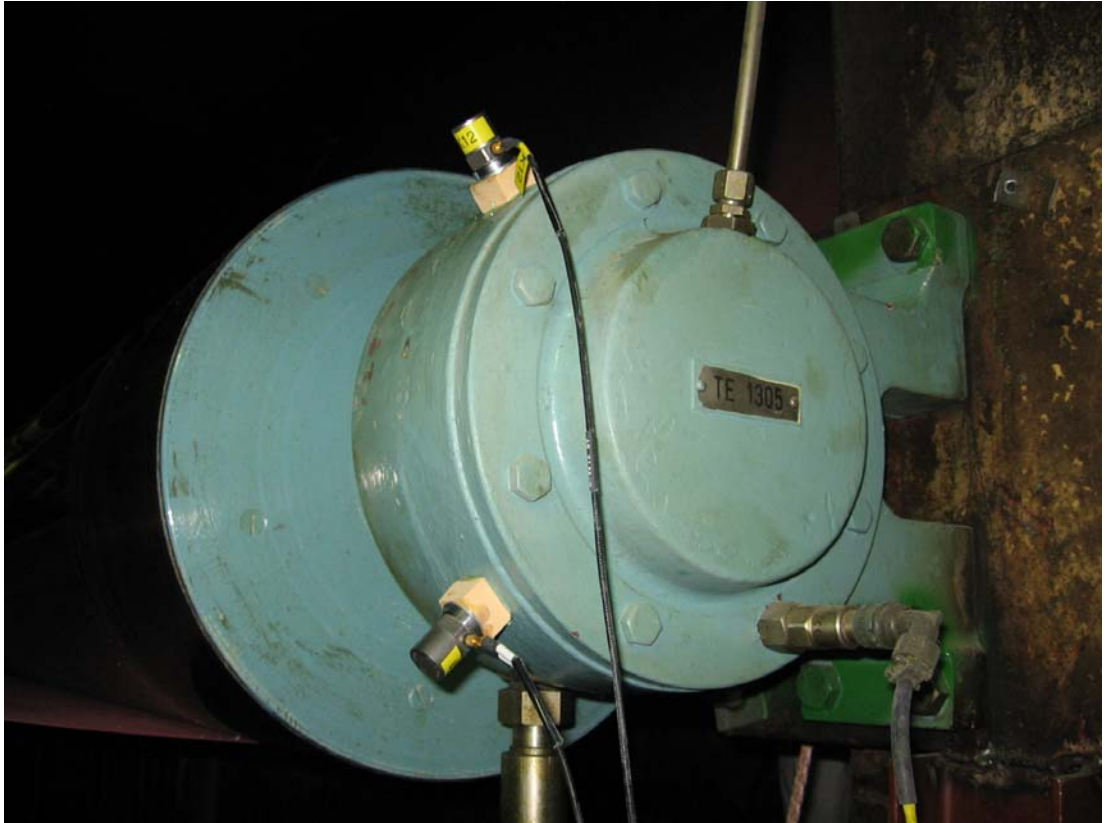
Kuva 10. Telaposition 099 anturointi. Laakeripesään on kiinnitetty kaksi kiihtyvyyssanturia, jotka ovat toisiinsa nähden kohtisuorassa. Toinen antureista mittaa kiihtyvyyttä viiran kulkusuunnassa ja toinen viiran normaalin suunnassa.
