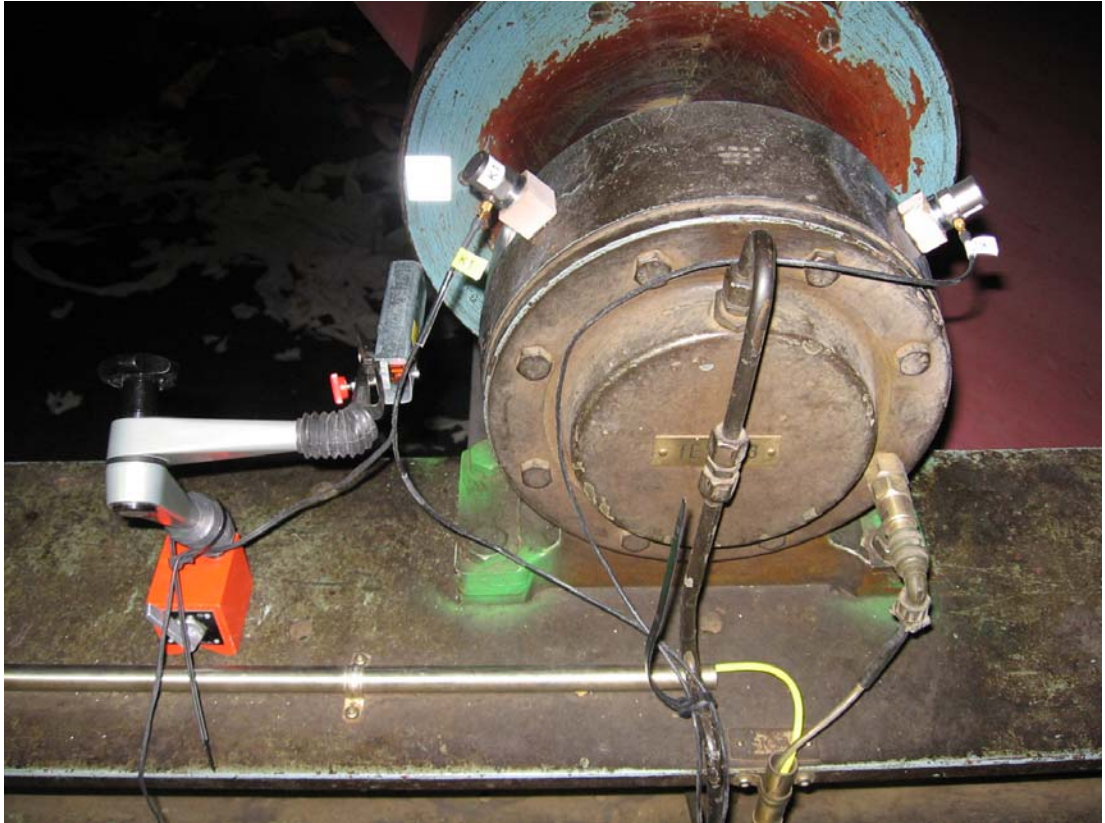
Kuva 11. Telaposition 104 anturointi. Tahdistusanturi ja heijastinteippi ovat kuvassa vasemmalla. Laakeripesään on kiinnitetty toisiinsa nähden kohtisuoraan kaksi kiihtyvyyssanturia.
